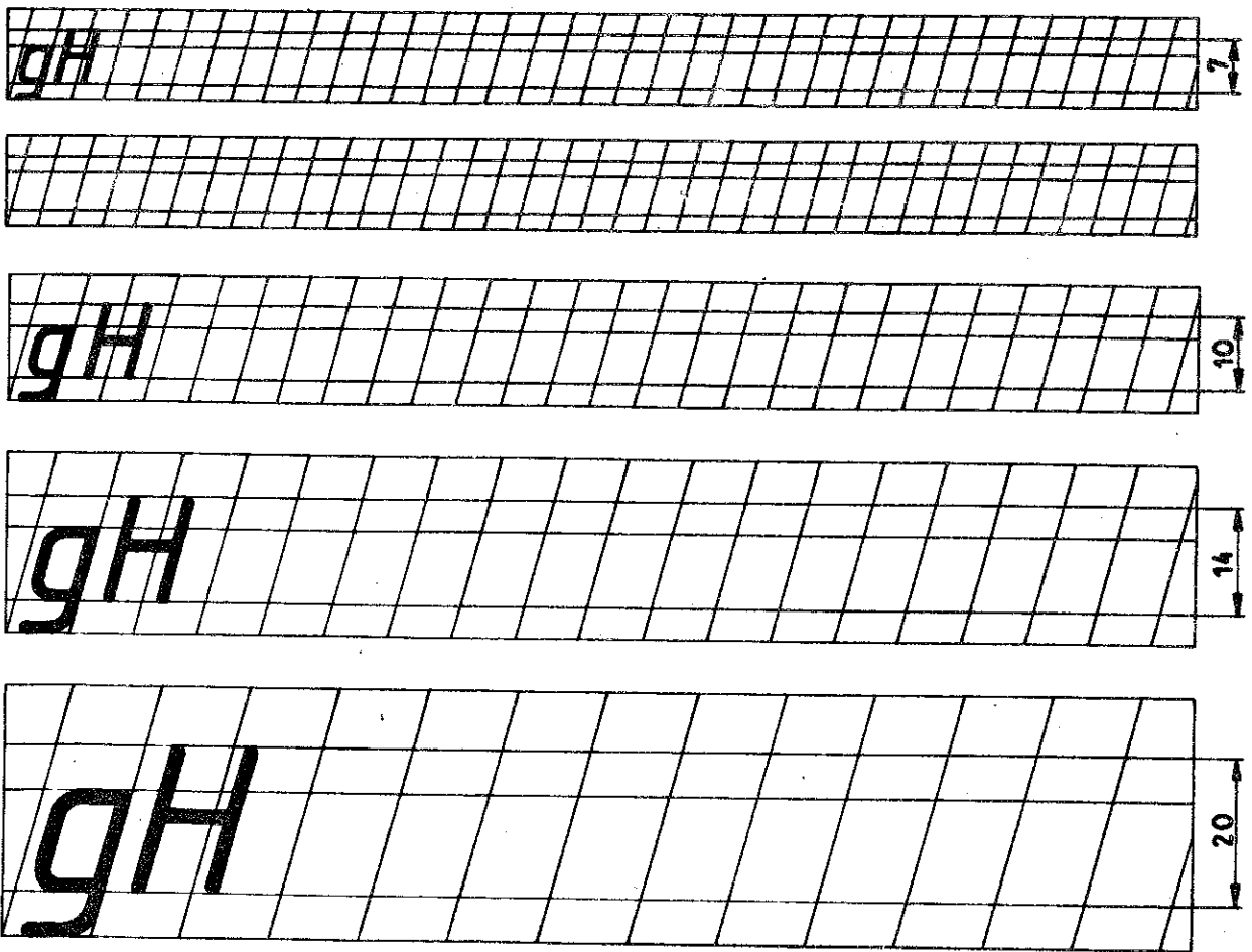
Linienblatt für Schrift nach TGL 31034/01 bis 05 Mittelschrift, schräg
