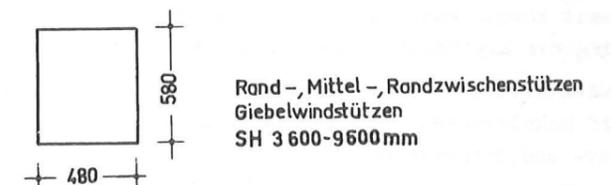
Bild 32 Rechteckvollstützen Rb 500 für eingeschossige Gebäude mit dem Achsabstand 12000 mm
