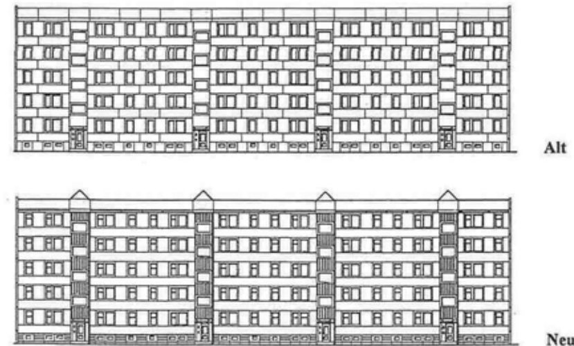
Bild 7.6: Eingangsfassade - Ideenskizze zur Neugestaltung
