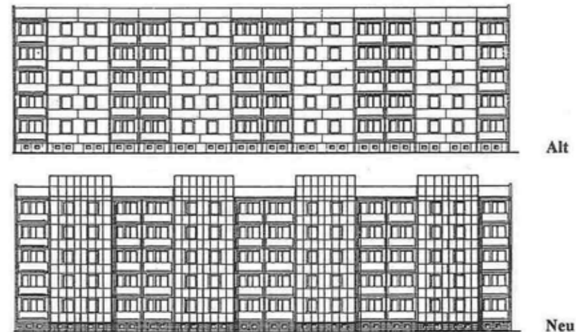
Bild 7.5: Loggiafassade - Ideenskizze zur Neugestaltung
